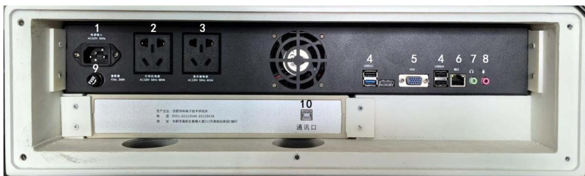
图 5-3 仪器主机背板接口示意图
