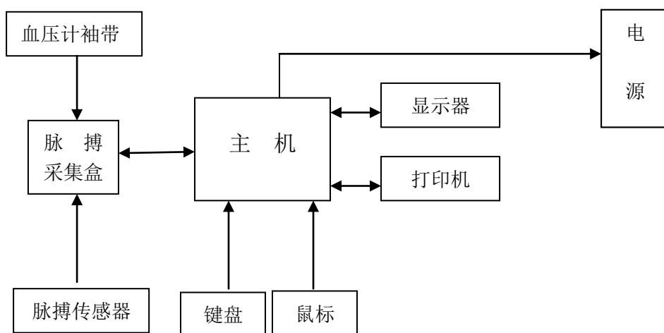
图 5-2 HK-X-B 自动心血管功能检测仪连接图
