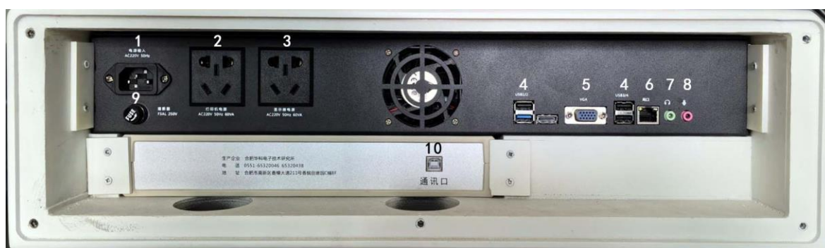
图 5-3 计算机接口示意图
